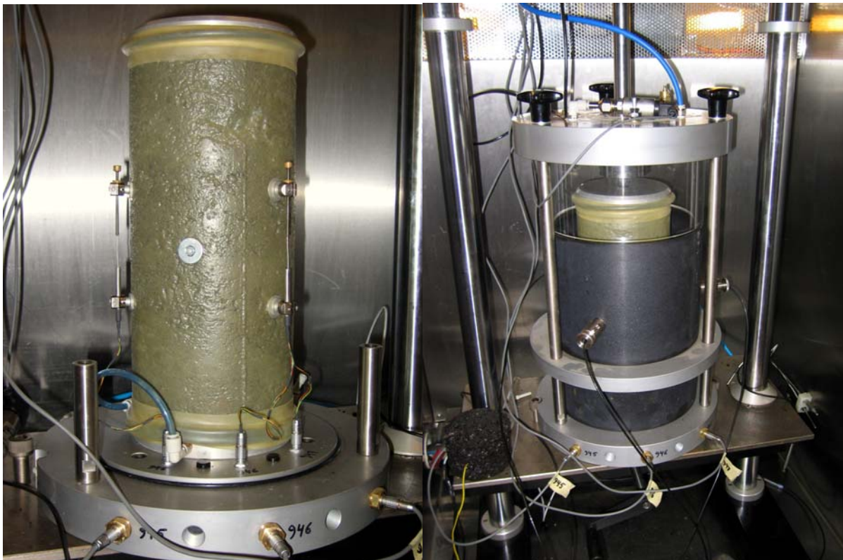
Figur 2-3 Triaxialprovkropp redo för testning
