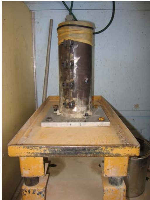
Figur 2-1 Form och vibrobord som användes vid inpackningen av triaxialprovkroppar
