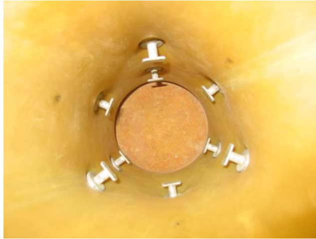
Figur 2-2 Givarhållare (s.k. "studs") på insidan av formen innan materialet lagts ner
